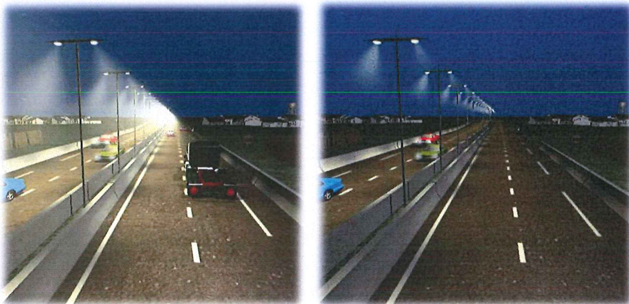
Fig. 9. Nivele de dimming în funcție de fluxul de trafic
